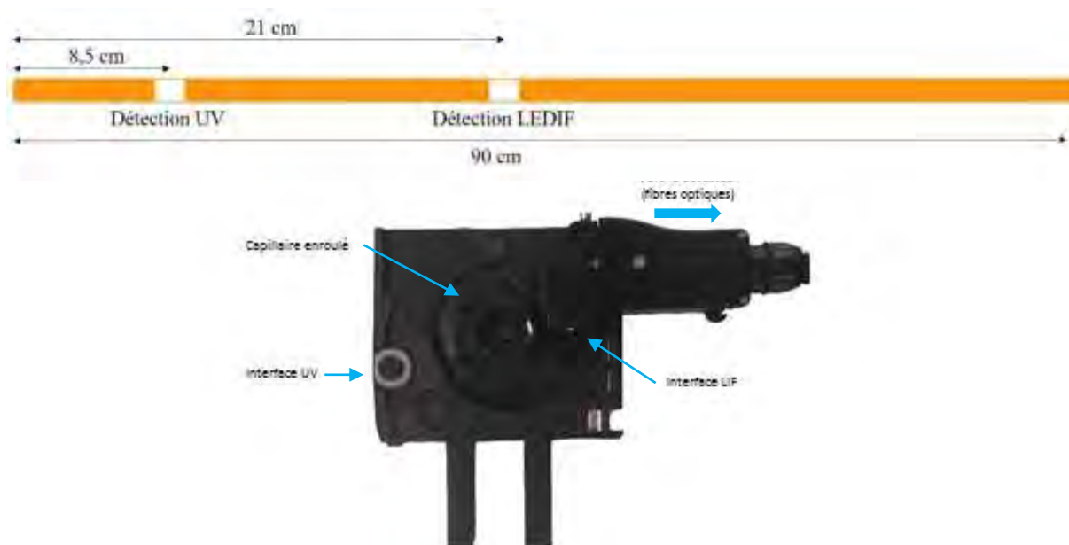
Figure 1-2 : Schéma du capillaire avec la double fenêtre UV et LIF ci-dessus et schéma de la cassette modifiée par Picometrics ci-dessous.
