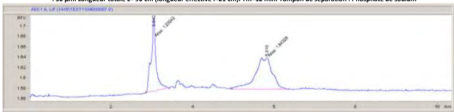
Figure 2-4: Analyse du complexe T29 50 nM + thrombine 500 nM par fluorescence à 488 nm. Capillaire en PVA - diamètre : 50 \mu\text{m} . Longueur totale L = 90 \text{ cm} (longueur effective l = 21 \text{ cm} ). T_m = 12 \text{ min} . Tampon de séparation : Phosphate de sodium
