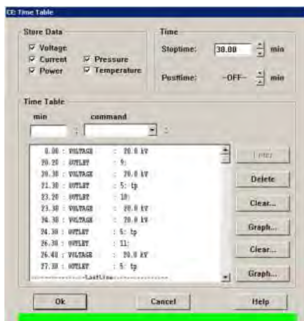
Figure 3-2 : Onglet time table sur l'instrument d'électrophorèse capillaire d'Agilent permettant de réaliser des collectes. Le vial 9 correspond au vial de collecte du sucre DP1 (designé ci-dessus par outlet 9), le vial 10 correspond au vial de collecte
