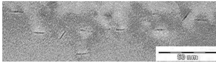
Figure 7: Vue « sur la tranche » d'une population de platelets observée en condition hors Bragg et lorsque la lentille objectif est défocalisée.
