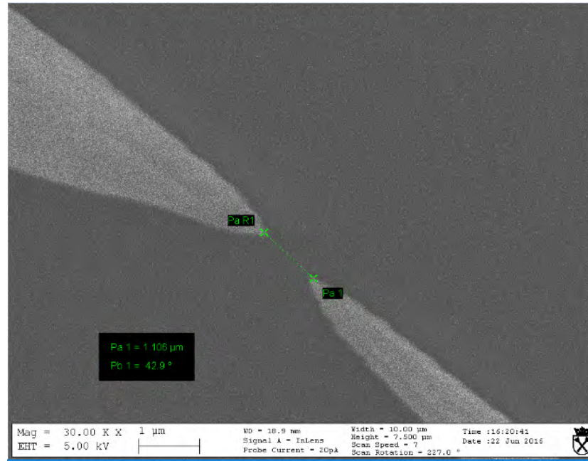
FIGURE 8.1 – Image SEM réalisée sur le 4-STM avec les paramètres indiqués (5kV ; 20pA). La distance inter-pointes ici est de 1,1 \mu m, sur Si(100) :H-(2×1) .
