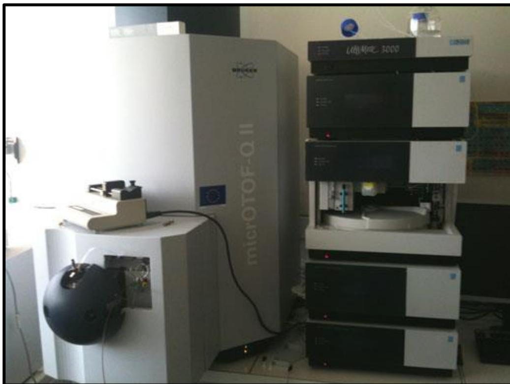
*Photo 7 : Photo du système de Chromatographie Liquide Haute Performance couplé à un détecteur de Spectrométrie de Masse (q-TOF).*
