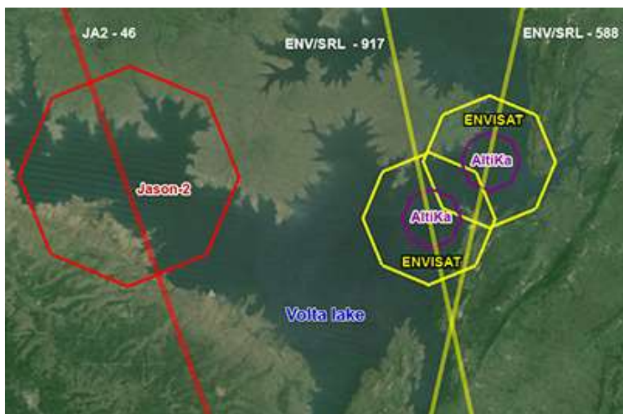
Figure 87 – Site du lac Volta. Les orbites ENVISAT/SARAL sont représentées en jaune, et les orbites Jason-2 en rouge. Les taches de mesure à -3 dB sont représentées par des octogones pour les trois satellites autour des trois stations virtuelles, en jaune pour ENVISAT RA-2, rouge pour Jason-2 et violet pour AltiKa.
