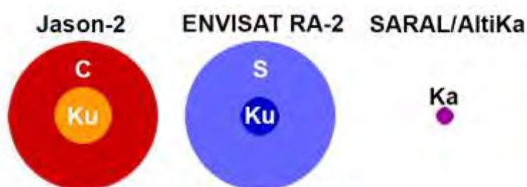
Figure 58 - Taille des taches de mesure au sol théoriques pour une surface totalement plane en fonction de la fréquence utilisée, pour les trois altimètres Jason-2, ENVISAT RA-2 et SARAL/AltiKa. Les dimensions sont proportionnées.
