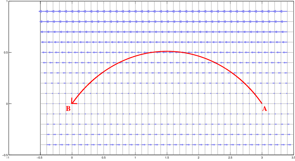
FIGURE 4.2 – Trajectoire optimale pour le problème de Zermelo dans le cas où le vent est de la forme u(x, y) = -Wy et v(x, y) = 0
