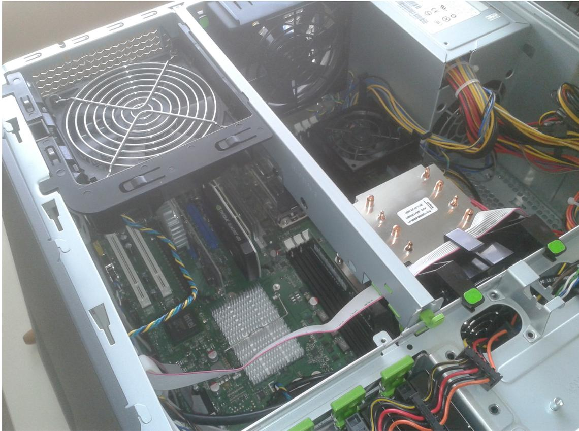
**Figure 3.19.:** Photographie du PC utilisé comme cible matérielle embarquée
