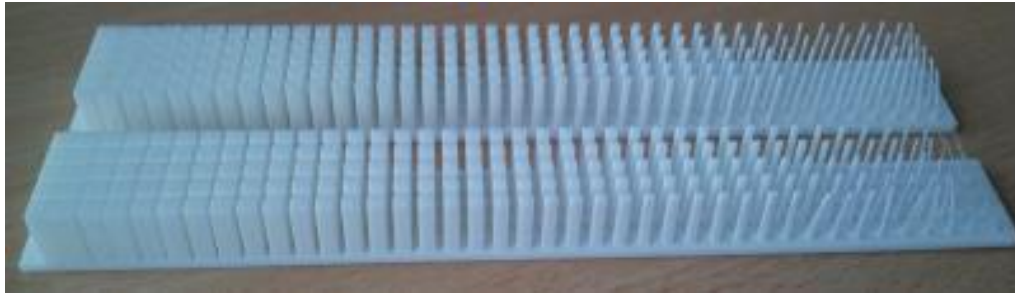
Figure 129 : Déformation des structures imprimées pour des largeurs de structure trop petites.
