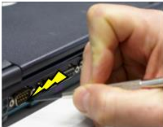
Figure 7: Cas d'une décharge de type « pistolet » dans un système électronique
