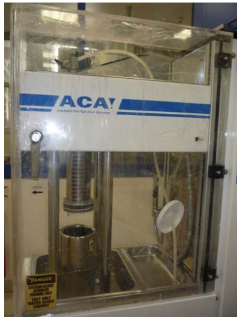
FIGURE II.9 — Automated Ultra High Shear Viscometer (ACAV) utilisé pour les mesures de rhéologie capillaire.
