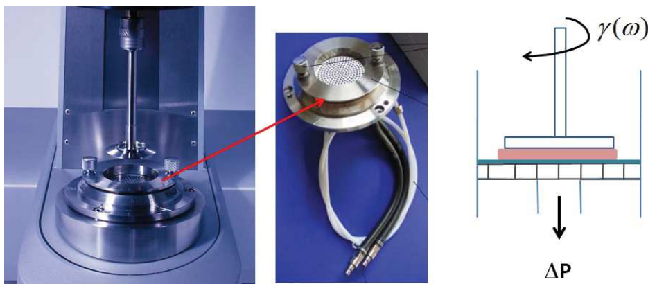
FIGURE III.3 – Gauche : cellule d'immobilisation montée sur le rhéomètre MCR 501 et détail de la géométrie inférieure comprenant la grille. Droite : schéma du montage vu de côté, avec la suspension (en rose) et le filtre (en bleu).
