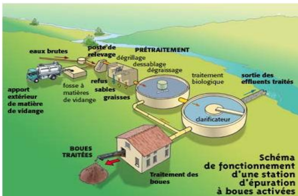
Figure 3. 1. Organisation et fonctionnement d'une station d'épuration
