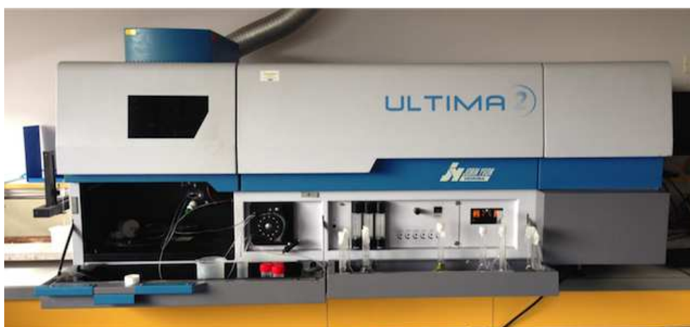
FIGURE III.4 – Photographie du moyen d'essai ICP
