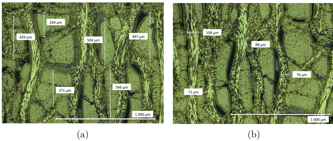
FIGURE II.3 – Macrostructure en coupe du C/C 2,5D : (a) épaisseur des plis et (b) des faisceaux de fibres transverses
