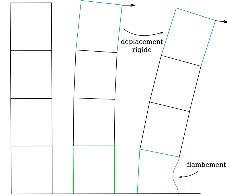
FIGURE 4.2 – Cas d’un déplacement de corps rigide d’un sous-domaine provoqué par le flambement d’un autre sous-domaine.
