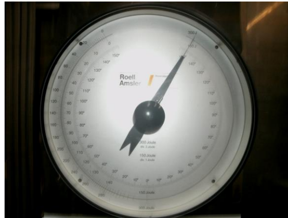
Figure 2.6 : Cadran de mesure sur le dispositif d'essai Charpy de l'ICA
