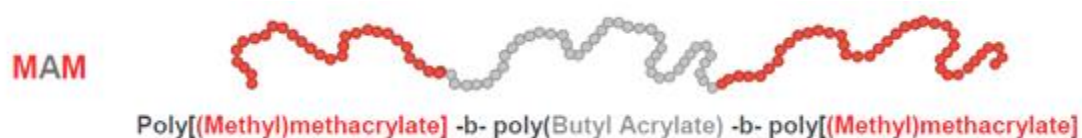
Figure 1.26 : Schéma d'un copolymère tribloc (Nanostrength®) d'Arkema [57]
