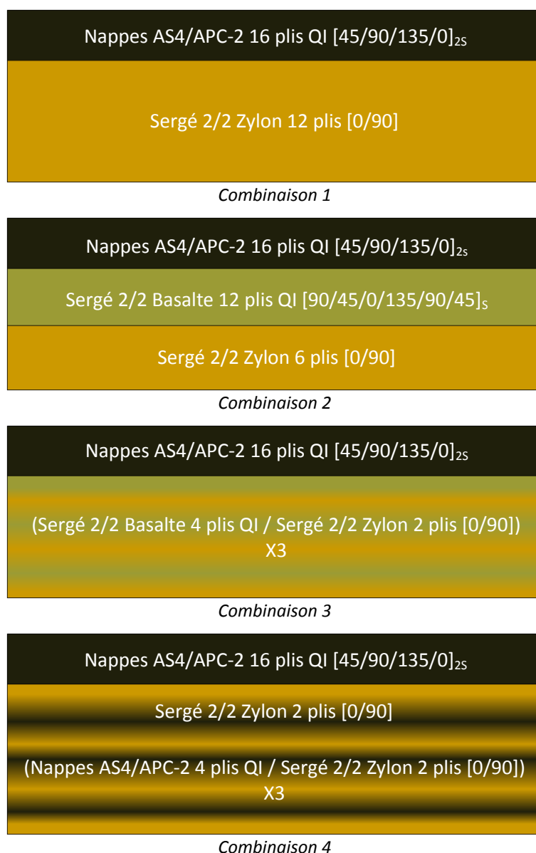
Figure 6.2 : Représentation schématique des différentes configurations multimatériaux testées
