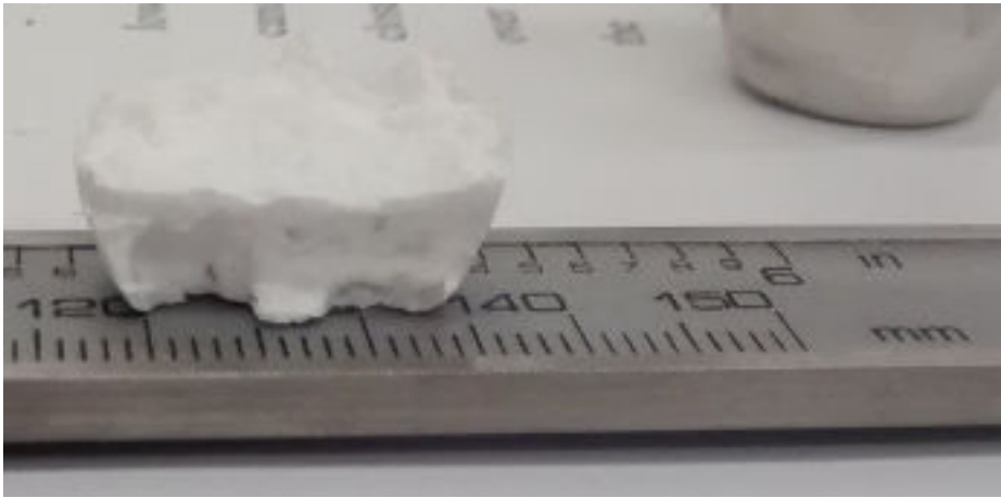
FIGURE 4.15 – Échantillon T06 après traitement thermique, retiré du creuset et fracturé verticalement. L’allure lisse traduit la présence d’une phase liquide, mais les reliefs et la cavité centrale prouvent qu’une phase solide dispersée importante apportait une consistance pâteuse.
