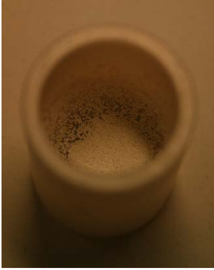
(a) Échantillon n°37 : 4.21 g, 89 wt% NS 2 -11 wt% CaO(M), soit une composition équivalente en oxydes de 58,7-11,0-30,3. Histoire thermique : 45 min à 900°C. Le creuset mesure 20 mm de diamètre.
