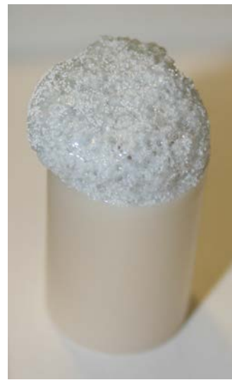
(b) Échantillon n°36 : 4.58 g, 82 wt% \text{NS}_2 -18 wt% \text{CaCO}_3 , soit une composition équivalente en oxydes de 58,7-11,0-30,3. Histoire thermique : 45 min à 900°C. Le creuset mesure 20 mm de diamètre.
