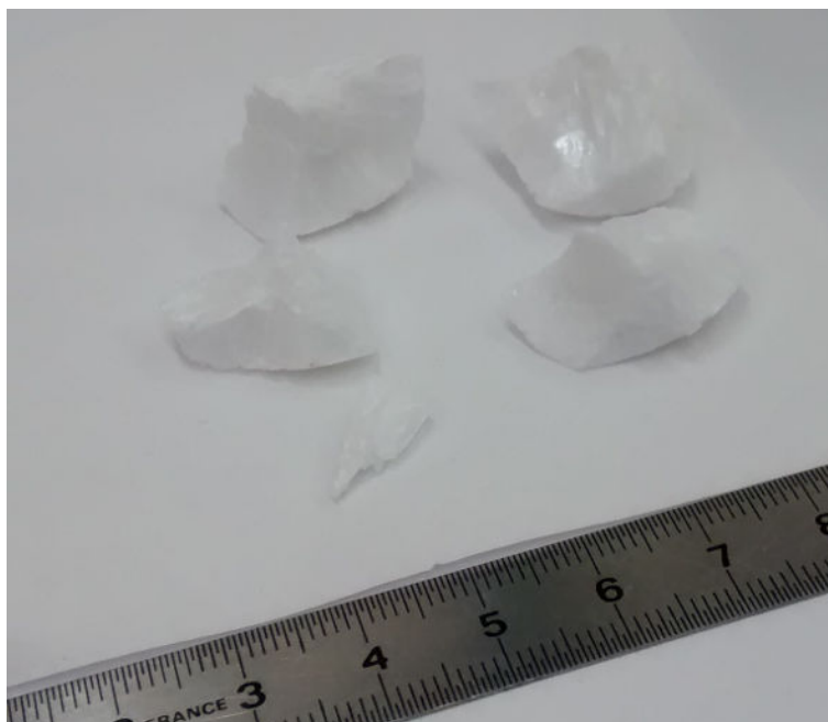
FIGURE 4.9 – Masse fracturée de 20 g de composition eutectique (T03) après fusion et trempe. On observe des lamelles brillantes et lisses, organisées de façon centripète.
