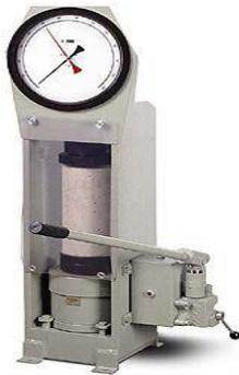
**Figure 4:** Presse béton manuelle
