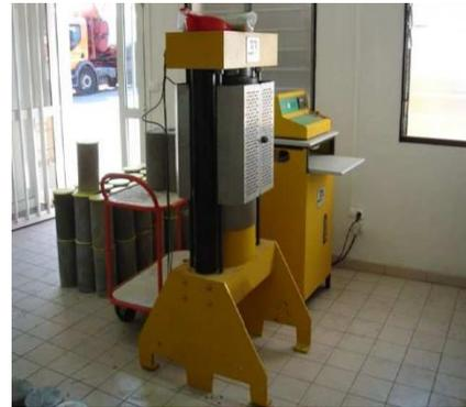
**Figure 5:** Presse béton électronique
