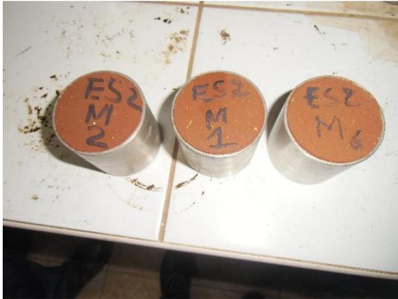
**Photo 34:** Epreuve pour Résistance à la compression diamétrale
