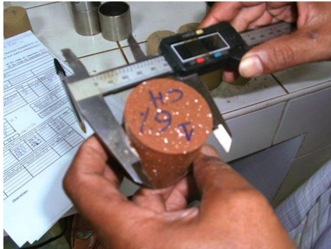
**Photo 39:** Contrôle de dimension de l'éprouvette après 7 jours d'imbibition
