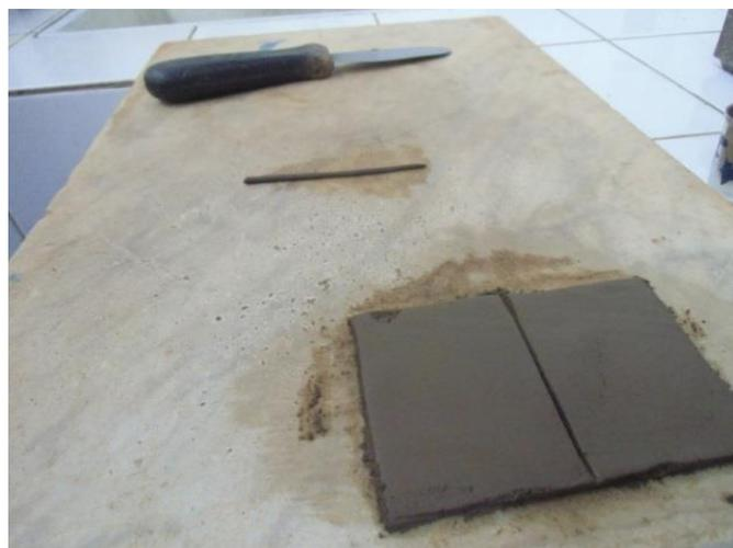
Photo 22: Détermination de la limite de plasticité
