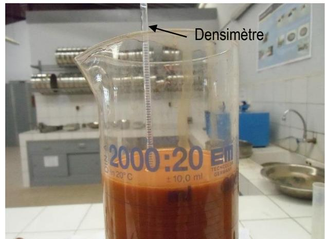
Photo 18: mesure de la densité
