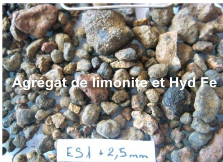
**Photo 42:** agrégat de limonite et d'hydroxyde fer dans la fraction 2,5mm d'ES1
