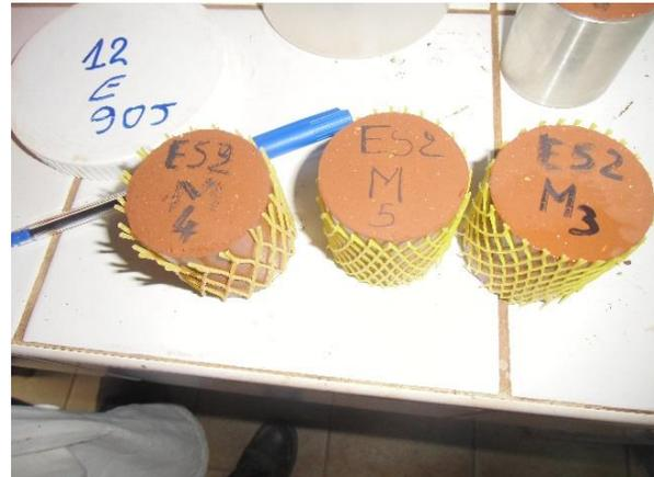
**Photo 35:** Epreuve pour essai au gonflement volumique
