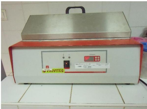
**Photo 36:** Bain thermostatique réglé à  $40^\circ C$
