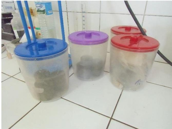
**Photo 38:** Conservation de l'éprouvette dans une chambre froide à 20°C pendant 28 jours
