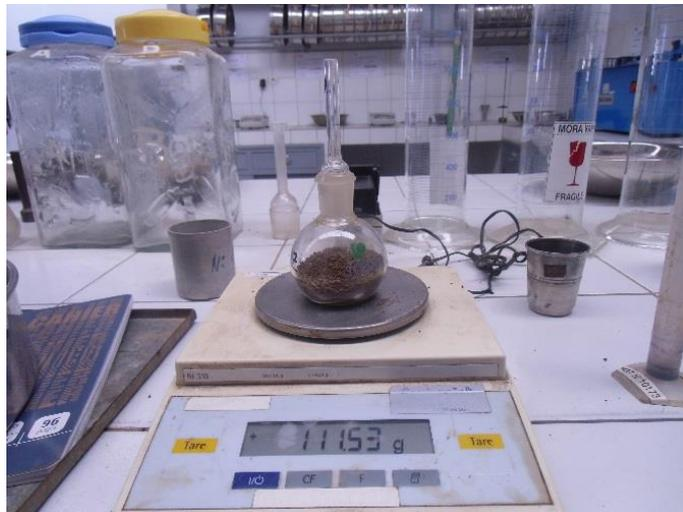
**Photo 25:** Pesage échantillon avec pycnomètre
