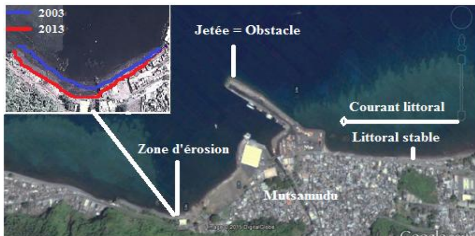
Figure 3 : Conséquence d'une jetée sur la plage
