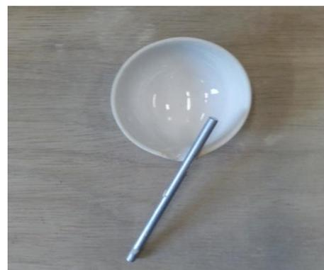
**Figure 7: Détermination de la limite de plasticité par la méthode du rouleau**
