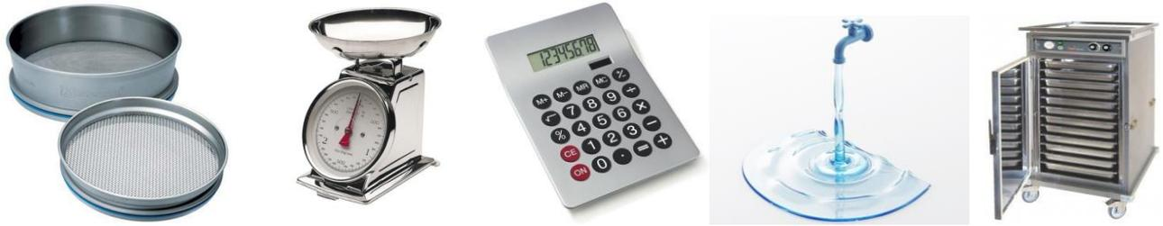
**Figure 9: Instruments nécessaires pour la granulométrie (Source : iDropProject.com)**
