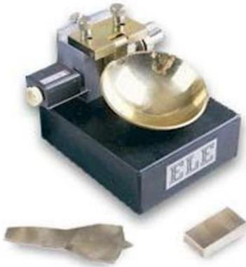
**Figure 8 : la coupelle de Casagrande (Source : iDropProject.com)**
