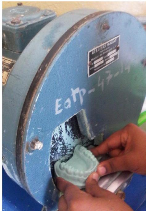
Figure 11: Taillage du plâtre (Photos prise par Houssen)
