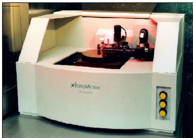
Figure 14 : Microscope à force atomique Accurex II
