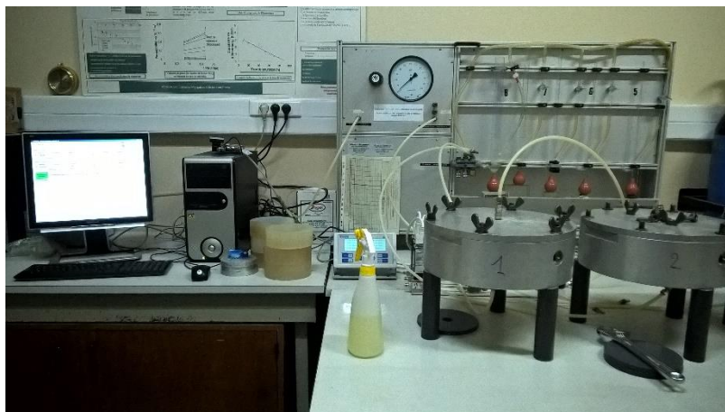
Figure A.10. Mesure de la perméabilité avec le perméamètre Cembureau
