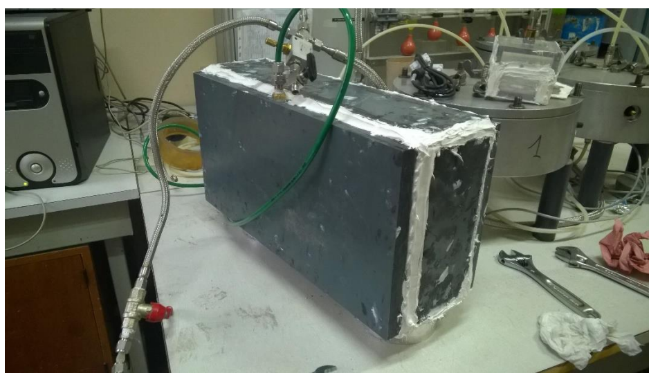
Figure A.12. Dalles équipées de cloche à vide pour mesure de la perméabilité en dépression à la cloche simple ou à la double cloche
