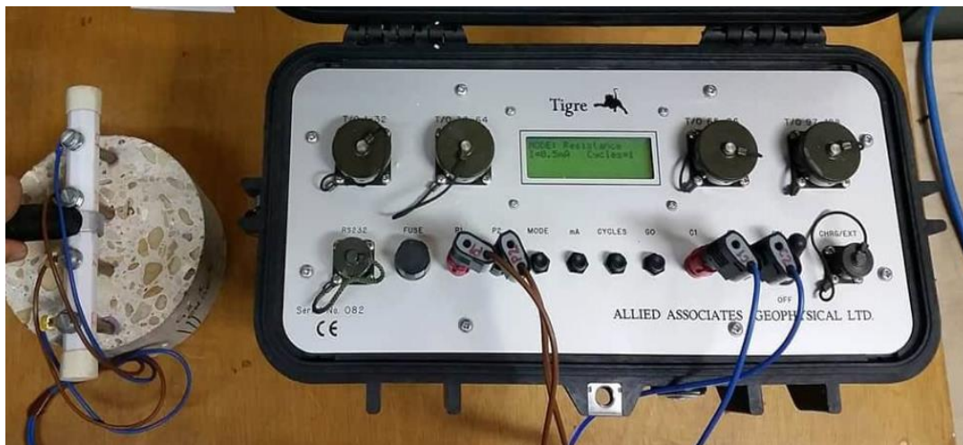
Figure A.14. Matériel de mesure de résistivité (quadripôle de Wenner + résistivimètre)
