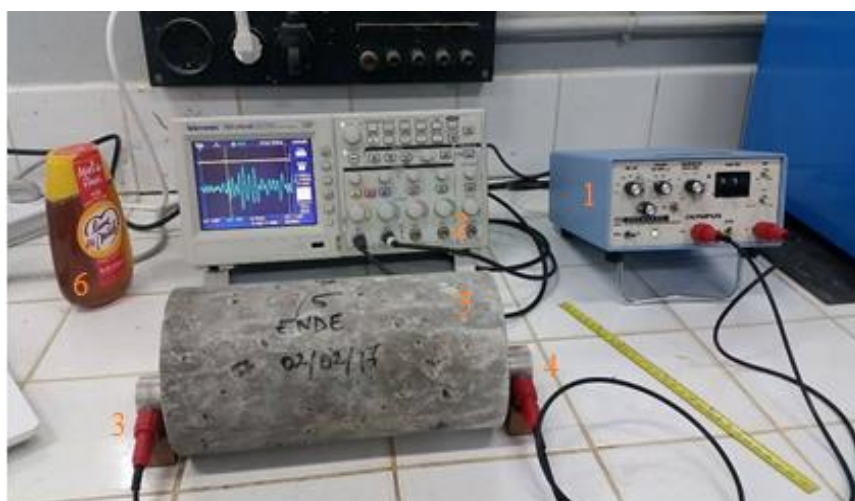
Figure A.15. Matériel de mesure des ultrasons en transmission directe
