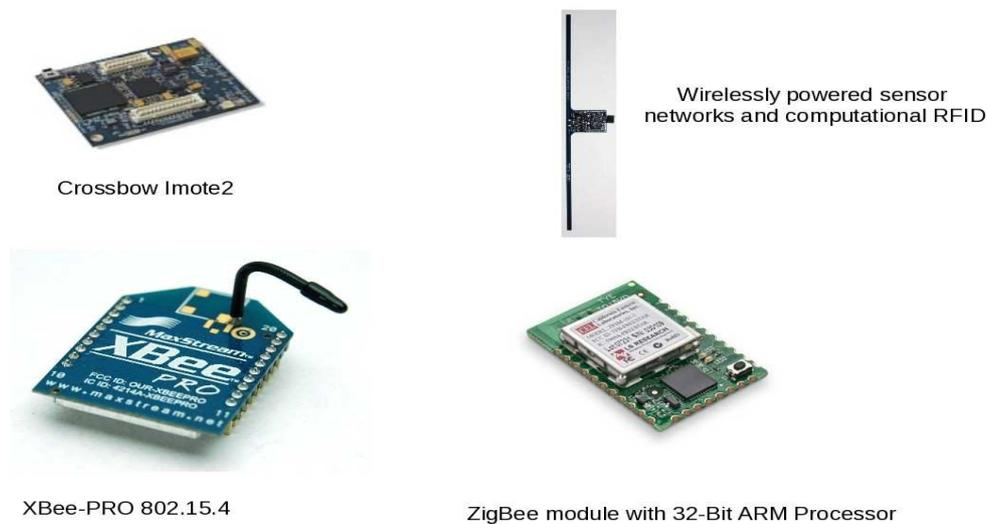
Figure 2.3: Plateformes de développement de réseaux de capteurs
