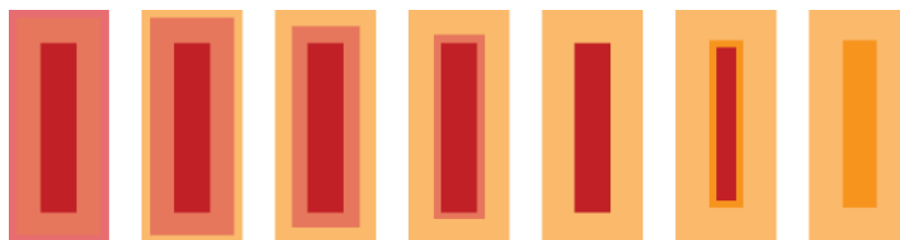
Figure 5-19 : Représentation schématique de la diffusion du cuivre dans une plaquette coeur-coque.
