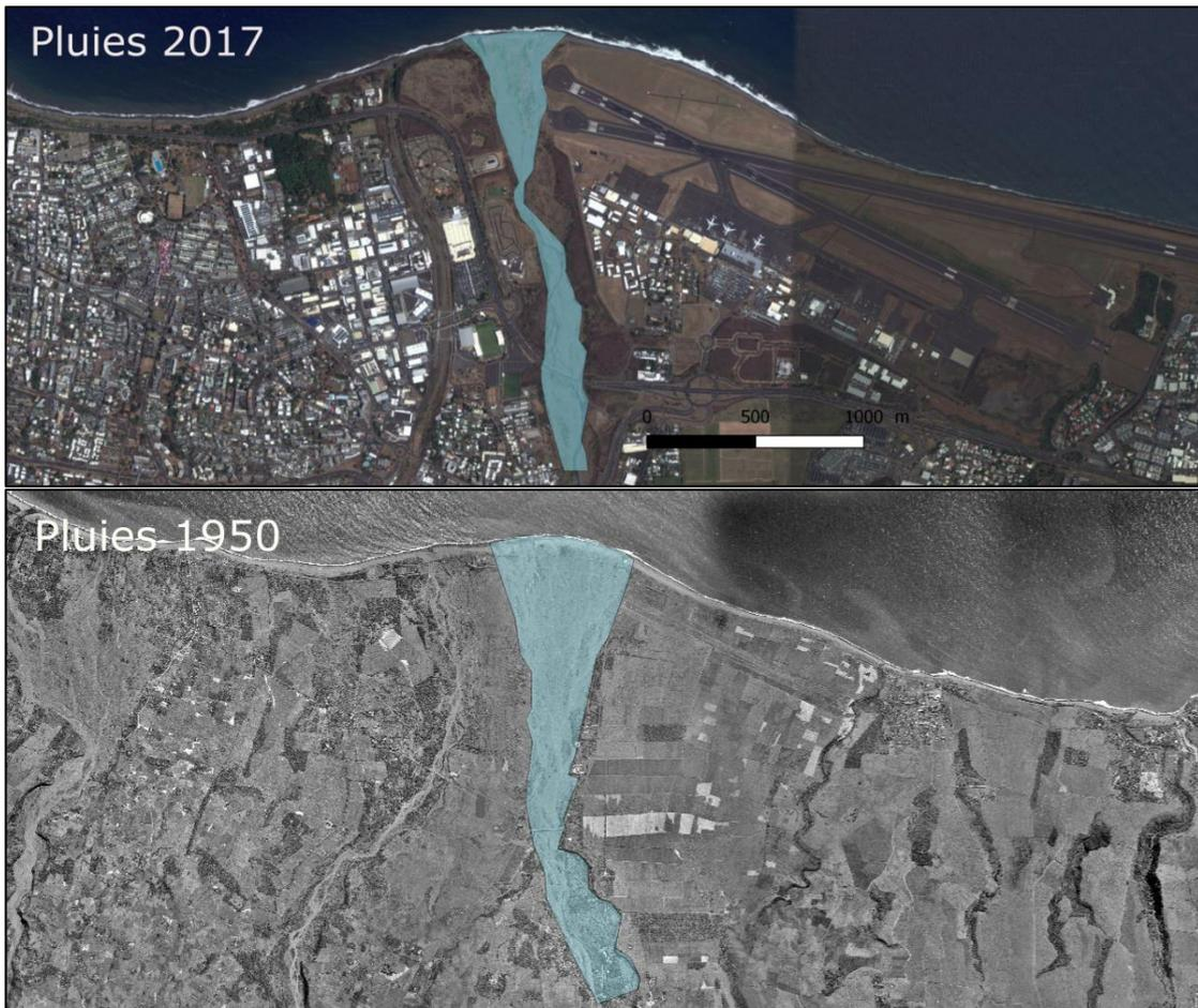
Figure 9. Cartographie de l'évolution du lit de la rivière des Pluies entre 1950 et 2017, réalisée à partir des photos de l'IGN, ©Thomas
