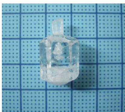
Figure 3.23 : cristal de YAB de dimensions 16 x 16 x 18 mm 3 synthétisé dans le flux \text{Li}_2\text{O} - \text{B}_2\text{O}_3 [72].
