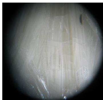
Figure 2.32 : photo du mélange de composition 40 CBF – 60 \text{CaF}_2 à l'issue du refroidissement lent.
