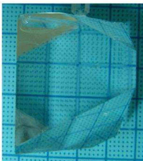
Figure 2.3 : cristal de CBO de dimensions 47 \times 45 \times 41 \text{ mm}^3 et d'une masse de 221 g synthétisé à partir d'un bain de composition 2 \text{ Cs}_2\text{O} - 3 \text{ B}_2\text{O}_3 - 2,5 \text{ MoO}_3 (proportions molaires) [24].
