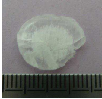
Figure 2.60 : photo d'une lame du cristal MCBF 1 coupée perpendiculairement à la direction de croissance.
