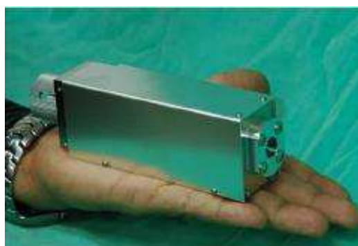
Figure 3.2 : photographie d'un prototype de microlaser utilisant BBO comme cristal non linéaire pour la GSH à 266 nm [7]
