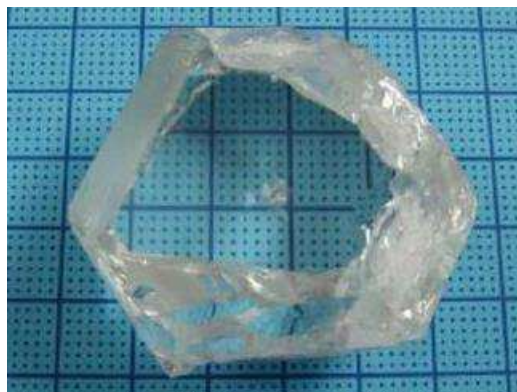
Figure 2.5 : monocristal de BABF obtenu en flux \text{LiF} - \text{B}_2\text{O}_3 - \text{NaF} [31].
