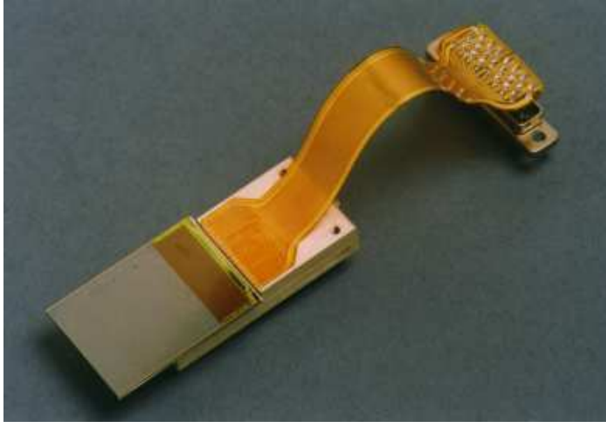
Figure I-2.15: Matrice CCD possédant une zone d'acquisition de 600 \text{ pixels} \times 600 \text{ pixels} de 40 \times 40 \mu\text{m}^2 . Le détecteur que nous utilisons est formé de six de ces matrices sous la forme de deux colonnes verticales adjacentes. Le câblage, qui relie la matrice à son électronique d'acquisition, est enveloppé de Kapton flexible, pour permettre à la matrice CCD d'être mise sous vide.
