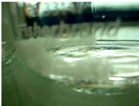
Figure 3.1.2. Présence au bas d'un flacon d'un précipité lié à un excès de Ga(III) dans un électrolyte sulfate de sodium (0,13 M) sans ions chlorure après 2 mois de conservation à pH 2,2.
