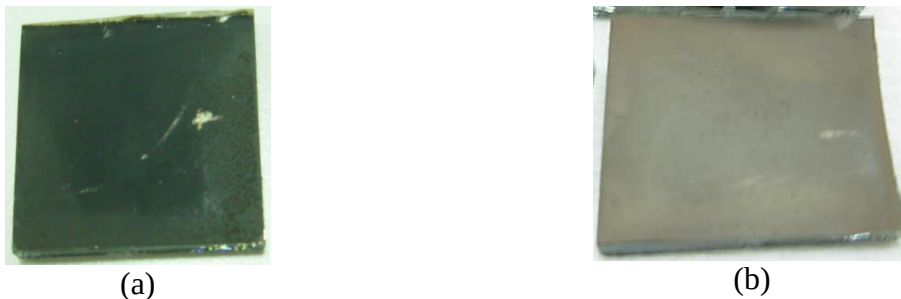
Figure 4.1.8. Photographies (a) avant et (b) après recuit réducteur.
