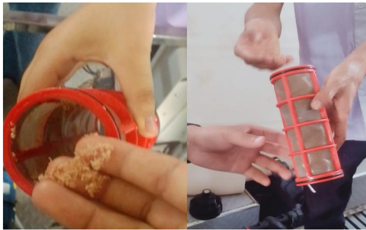
Figure 15 : Les filtres à tamis
