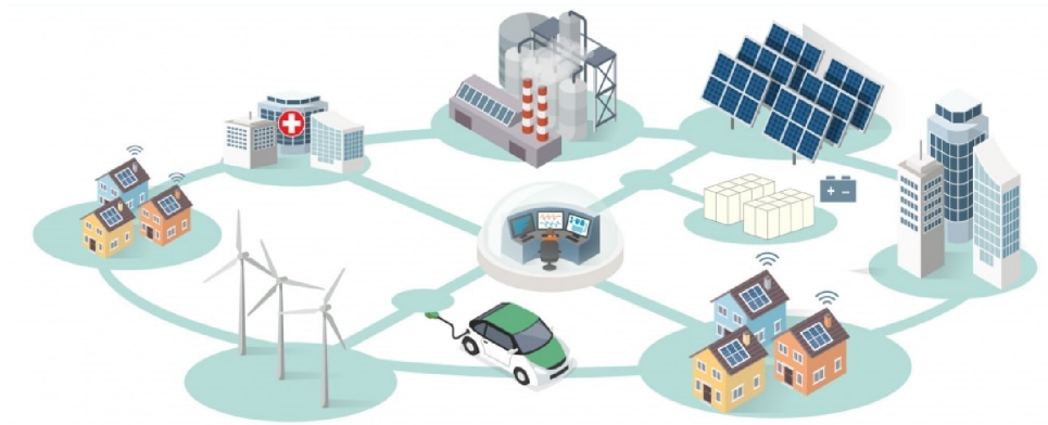
FIG. 4 – Schéma d'un microgrid regroupant producteurs, stockeurs et consommateurs [22]
