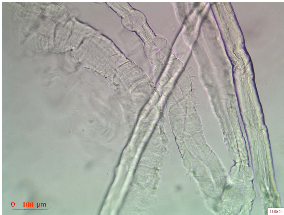
Figure 4: Observation microscopique d'une fibre séchée (S03) dans un mélange 6%NaOH-eau
