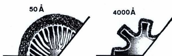
Figure II-2 : Représentation schématique de la distribution du dérivé de cellulose à la surface d'une particule de gel de silice selon le diamètre des pores de la matrice (extrait de la réf. (259))
