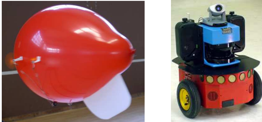
FIG. 2: L'utilisation de la vision permet de simplifier les dispositifs expérimentaux : une caméra monoculaire sans fil peut être facilement fixée à un ballon de baudruche gonflé à l'hélium (gauche), alors que l'utilisation d'un télémètre laser requiert une plate-forme plus imposante, dotée d'une charge utile et de réserves d'énergies conséquentes, comme en atteste le Pioneer 3DX d'ActivMedia Robotics (droite).
