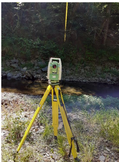
Annexe 6: Utilisation d'un théodolite pour réaliser une coupe transversale de la rivière Leitzaran
