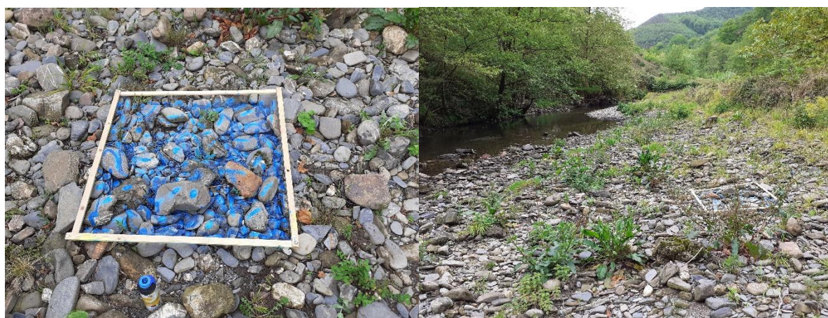
Figure 9: Echantillonnage de Surface par cadre sur la barre contrôle Olloki 0
