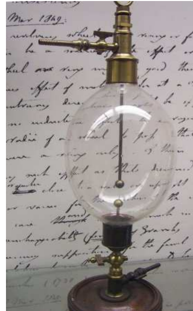
Fig 22 : Appareil utilisé par Faraday pour étudier les décharges électriques. L'arrière plan est un manuscrit de Faraday du musée qui lui est consacré à Londres
