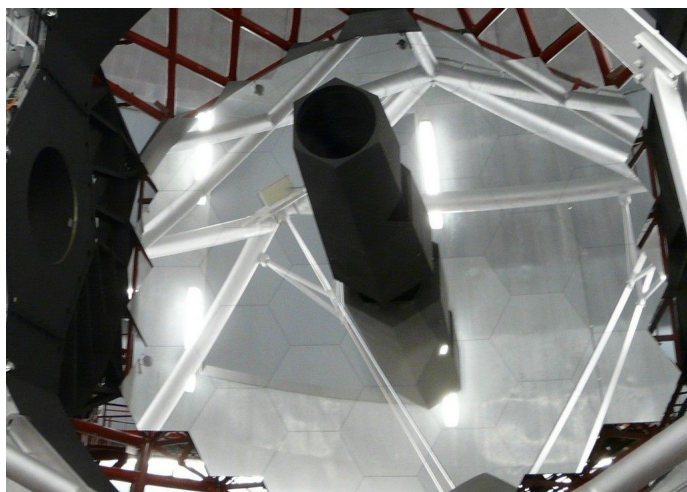
FIGURE 1.4 – Miroir primaire du télescope Keck à Hawaï, composé de 36 segments hexagonaux dont on peut voir les contours, et qui forment un miroir de 10 m de diamètre. © Jean-Baptiste Feldmann.
