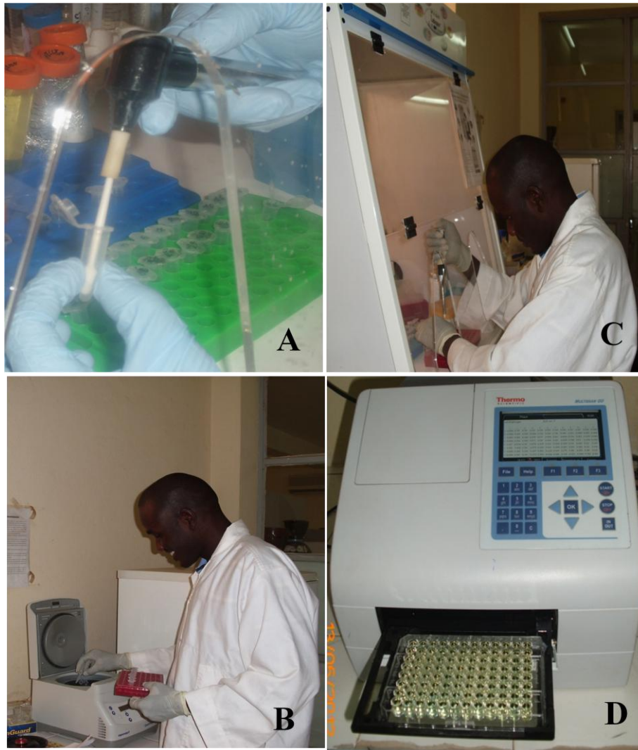
Figure 21 : Dosage des métabolites. (A) broyage du moustique, (B) centrifugation, (C) dosage sous hotte aspirante et, (D) lecture au spectrophotomètre Thermo Multiskan (Photo MH).
