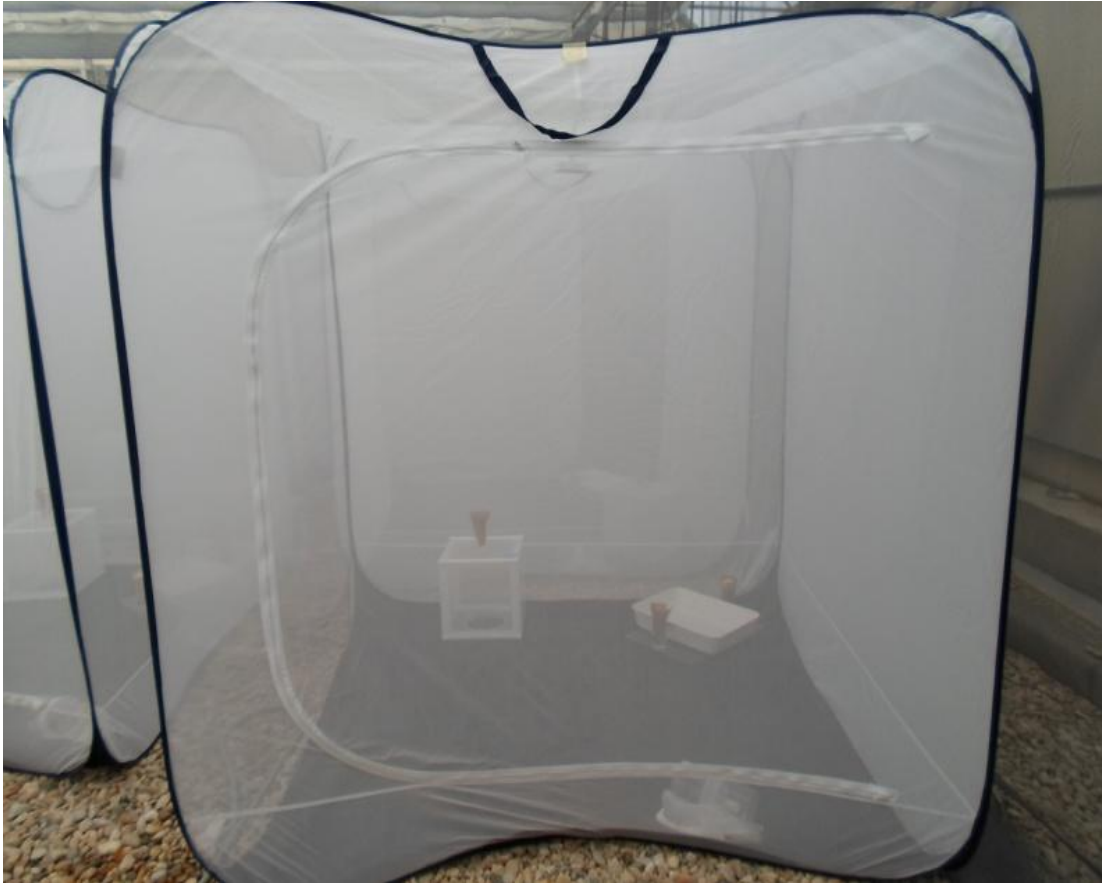
Figure 44 : Grande cage d'environ 1,75 m 2 , dans la serre expérimentale ayant servi aux tests de compétitivité sexuelle des moustiques stériles vs non traités.
