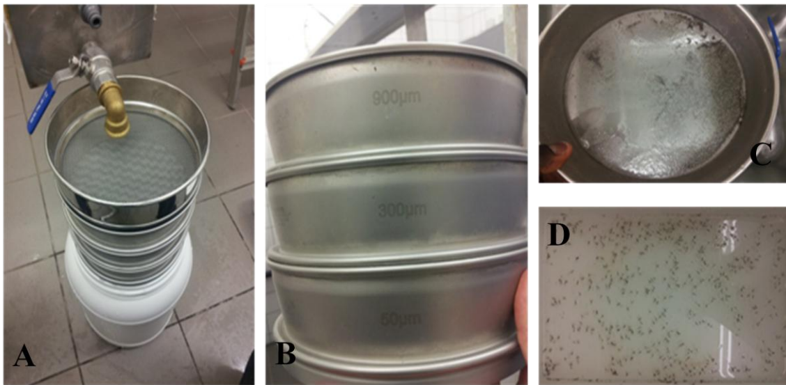
Figure 17 : Système de tamisage (A), à l'aide de tamis de différentes tailles (B) pour séparer les œufs (C) des adultes morts (D).
