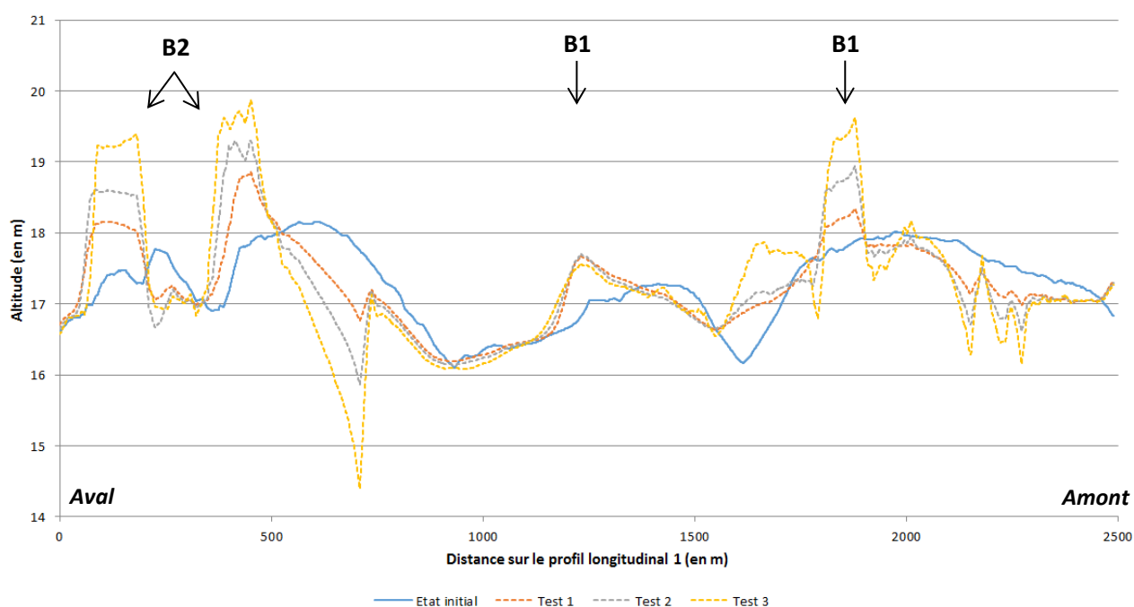
Figure 19: Evolution du profil longitudinal 1 en fonction de la rugosité du domaine
