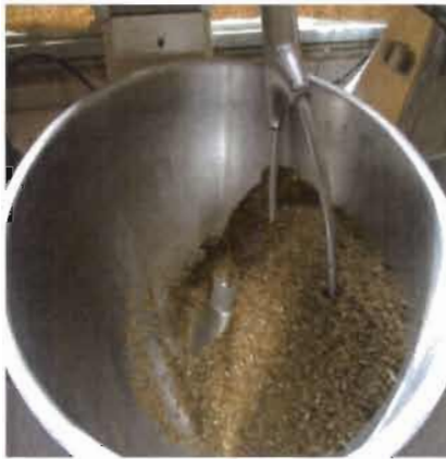
Photo 5 : fabrication de l'aliment ; (à gauche) mélange des ingrédients et (à droite) production des spaghettis d'aliment de 3,5 mm de diamètre.
