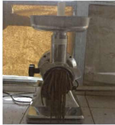
Photo 5 : fabrication de l'aliment ; (à gauche) mélange des ingrédients et (à droite) production des spaghettis d'aliment de 3,5 mm de diamètre.
