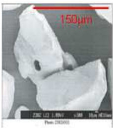
FIGURE 3.9 – Photographie de SiC 150 μm par microscopie électronique à balayage. Photographie de P. Gueroult IFPEN.
