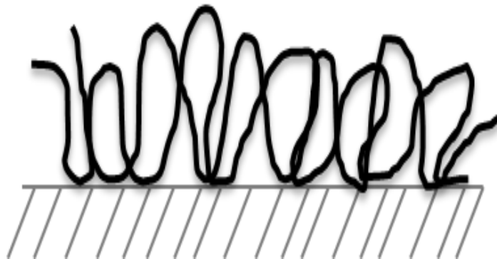
Figure 13 : Schéma de l'adsorption des polymères sur la surface de milieu poreux [26]
