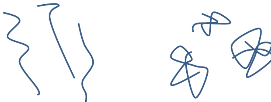
Figure 10 : Comportement des polymères HPAM dans les solutions salines. A gauche, les chaînes polymères sont étirées (faible salinité). A droite, les chaînes de polymères sont compactes (fortes salinités).
