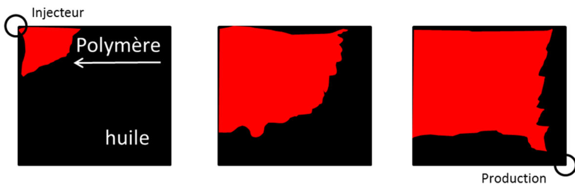
Figure 7 : Polymer flooding : Ratio de mobilité M < 1 .
