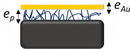
Figure III 2 Représentation schématisée d'une bicouche pNIPAM / Or.
