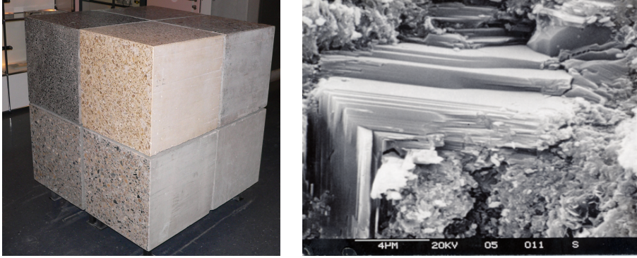
FIGURE 1.1 – La structure apparente du béton change en fonction de l'échelle d'observation. À gauche, des blocs de béton de 50 cm de côté, mélange solide de ciment et de graviers (Image Wikimedia Commons). À droite, une vue microscopique d'un ciment Portland hydraté : cristaux de portlandite Ca(OH)_2 dans une matrice de silicates de calcium hydratés nanocristallisés C-S-H (Image CEA).
