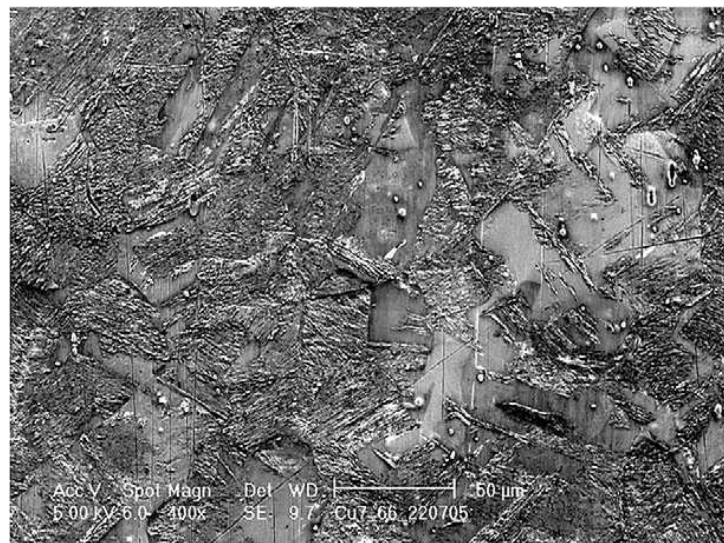
Figure I.4.5 Image de la surface de l'éprouvette à \Delta\sigma/2 = 61.1 MPa 1.5 \times 10^{10} cycles
