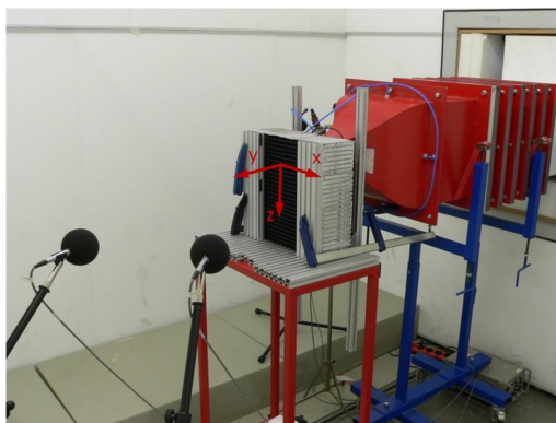
Figure 2.12: Montage d'un échangeur à la sortie du jet d'air dans la chambre semi-anéchoïque de l'Université de Siegen. Figure extraite d'un rapport d'essai effectué à l'Université de Siegen dans le cadre d'Ecoquest
