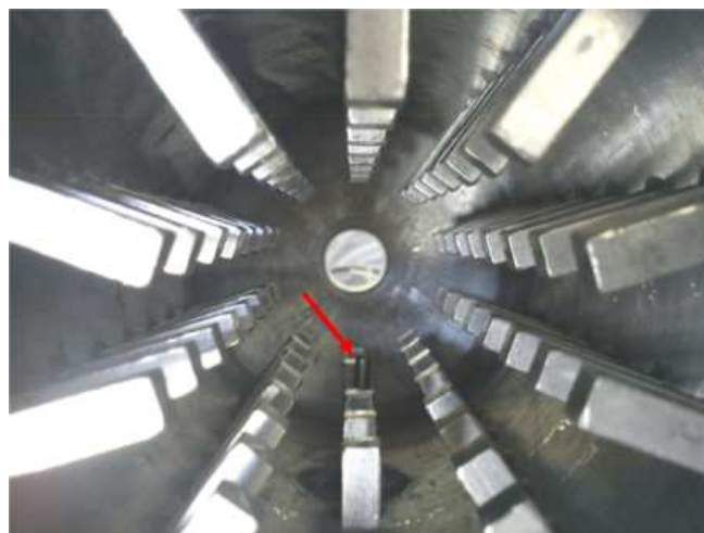
FIGURE II.7 – La sonde de température remplaçant une dent du stator et dont la position radiale est ajustable, permet la mesure de la température du mélange et la commande de l’ultra-cryostat
