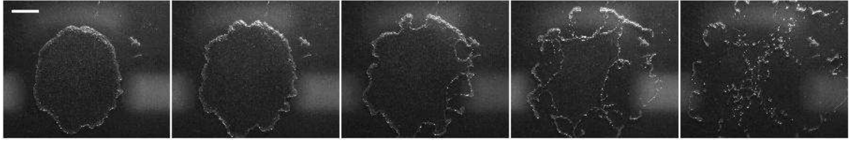
FIGURE 7.17 – La goutte peut se déstabiliser par les bords. Ici, H = 0,38 mm, la barre d'échelle indique 1 cm et deux images sont séparées de 6 ms.
