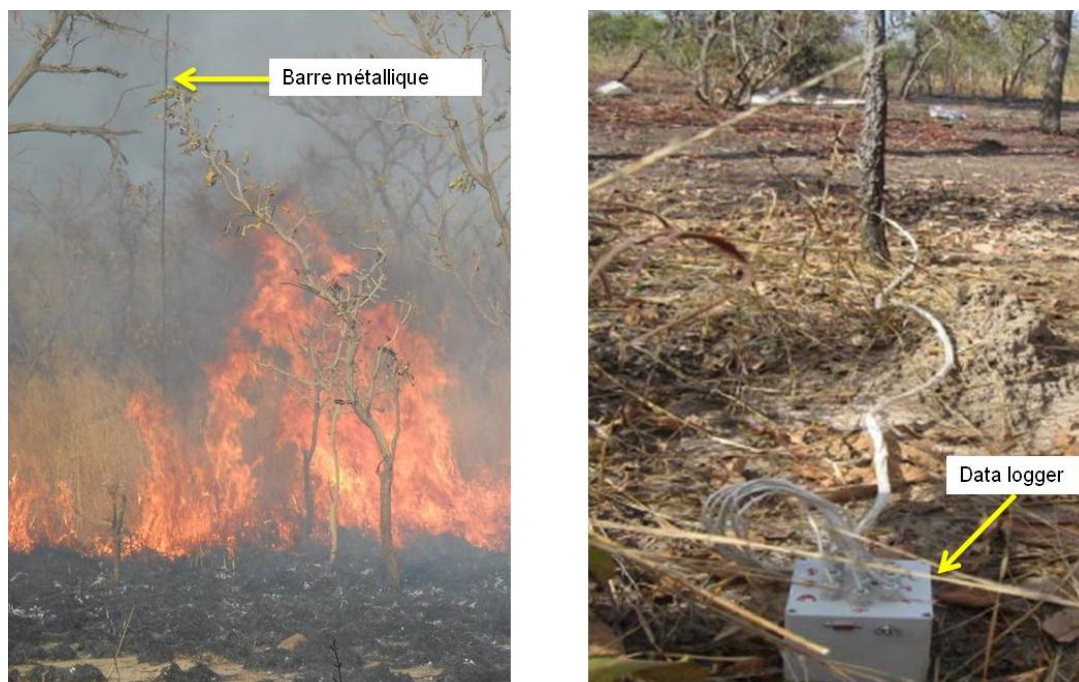
Photo 4 : Barre métallique portant les senseurs à différentes hauteurs lors du feu (à gauche) et MiniCube data logger (à droite). (Photo : Santi S. 2011)
