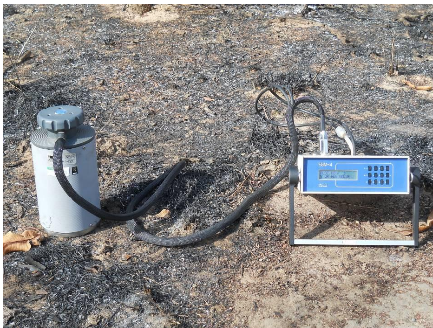
Photo 5 : Mesure de l'efflux de CO 2 et la respiration du sol à l'aide du Soil Respirometer Chamber (à gauche) connecté à l'EGM-4 (à droite).
