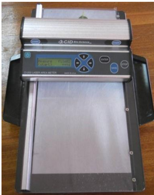
Photo 10 : Mesure de la surface foliaire d'une foliole avec le Leaf Area Meter (Modèle CI-202, CIID Inc. USA)
