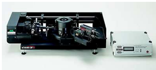
FIGURE 3.17 – Photo du goniomètre utilisé, le CGS-3 (Compact Goniometer System) de Malvern Instruments.
