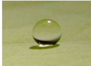
FIGURE 3 – Une goutte d'eau posée sur une feuille de Lotus forme un angle de contact proche de 180^\circ . Photo : M. Reyssat et S. Saint-Jean.
