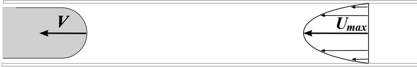
FIGURE 5.9 – Schéma de l'écoulement derrière une goutte dans le référentiel du tube. La goutte se déplace à vitesse V , entraînant avec elle du liquide dans le tube. Loin de la goutte, on s'attend à un écoulement de Poiseuille, dont la vitesse maximale U_{max} est différente de V .
