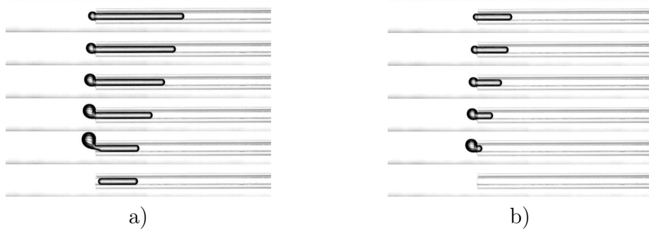
FIGURE 6.11 – Effet de la gravité sur l'extraction d'une bulle d'air d'un tube de rayon R = 0.3 mm et de longueur L_T = 52 mm. a) La bulle a une longueur L = 8.5 mm. Lors de sa sortie, elle se coupe en deux parties : une bulle de rayon 0.65 mm s'échappe du tube et l'autre partie (de longueur 3.4 mm) reste coincée. b) L = 3.4 mm : la goutte est plus courte et peut sortir du tube sans se briser, en accord avec l'équation (6.15)
