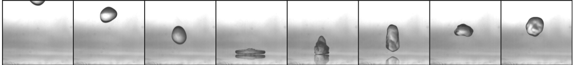
FIGURE 3.16 – Rebond d'une goutte d'oxygène liquide sur une plaque de verre à température ambiante. La goutte fait 1 mm de rayon et arrive avec une vitesse verticale d'environ 50 cm/s. Intervalle de temps entre les images : 5 ms.
